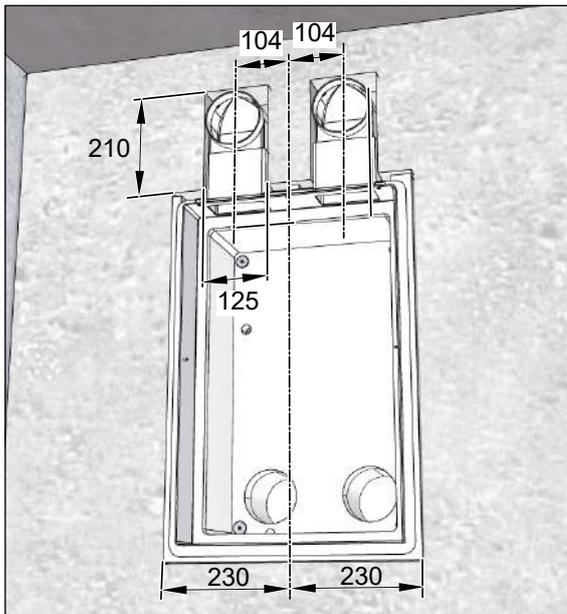
Abb. 12: Beispiel für vertikale Flachkanalführung, Maße in Millimeter
