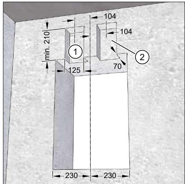
Abb. 11: Mauernuten für Flachkanalanschlüsse fräsen, Maße in Millimeter
