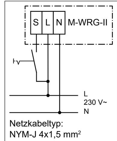
Abb. 48: Anschlussplan für ext. Steuereingang
