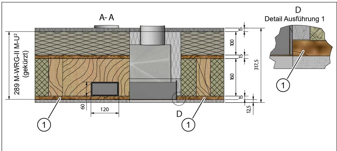
Abb. 55: Innere OSB-Platte als Dampfbremse und luftdichte Ebene
