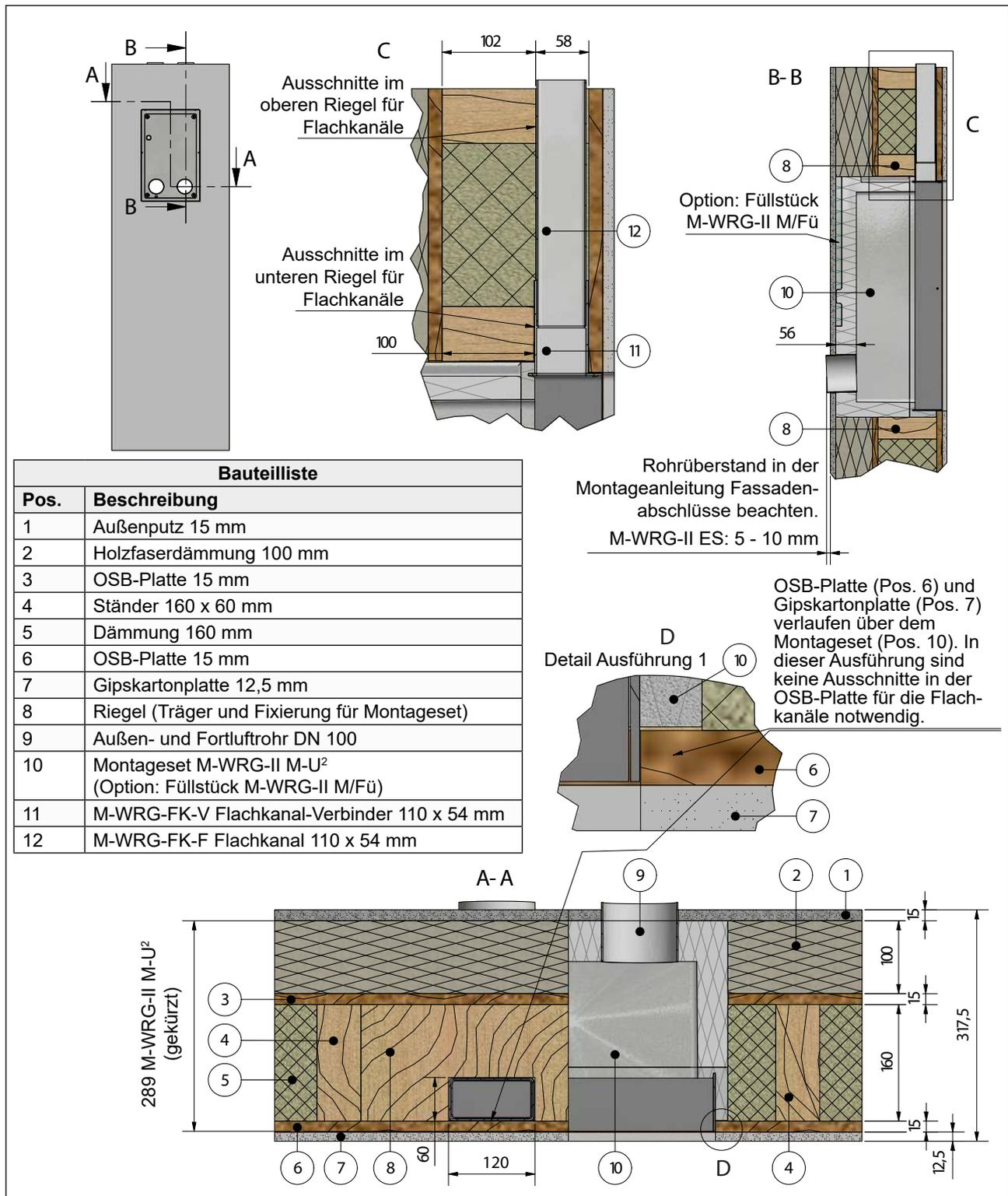
Abb. 6: Planungsbeispiel für den Einbau des Montagesets in eine Ständerkonstruktion mit einer Ständerstärke von 160 mm
