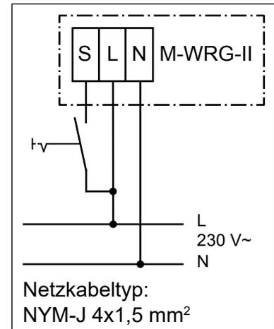
Abb. 20: Anschlussplan für ext. Steuerungseingang
