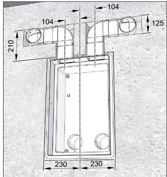
Abb. 13: Beispiel für horizontale Flachkanalführung, Maße in Millimeter
