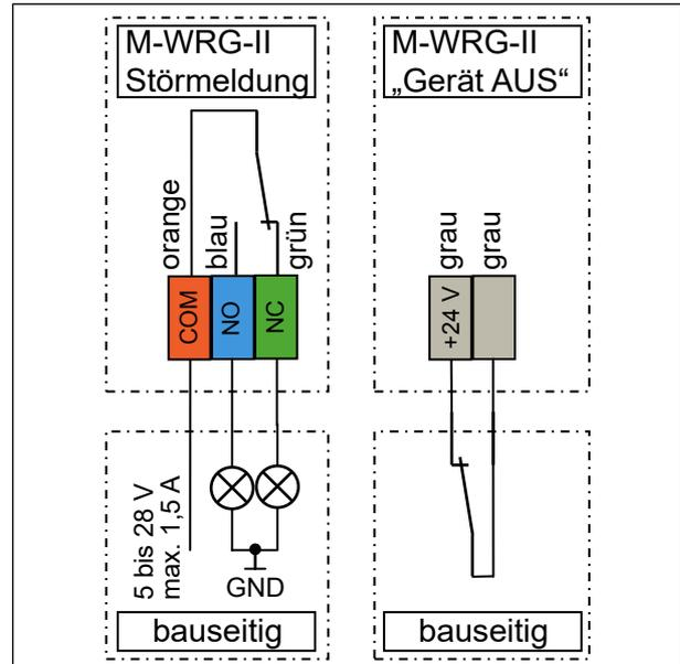
Abb. 49: Anschlusspläne für Option M-WRG-II O/EGG-AUS
